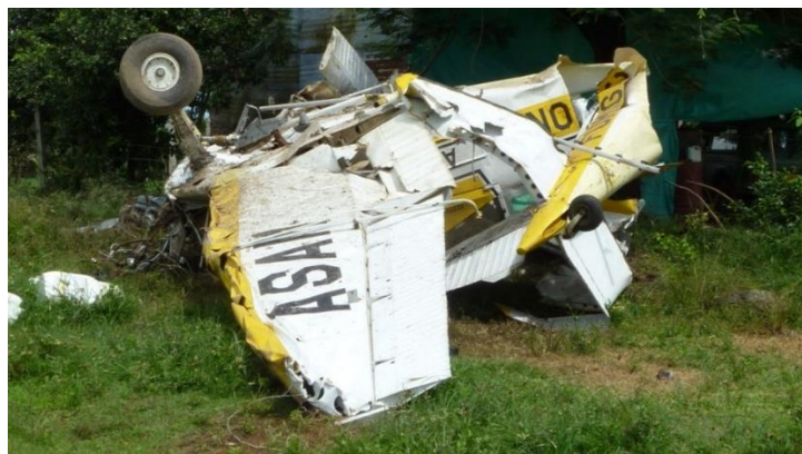
Imagen No. 4 – Accidente aviación agrícola por pérdida de control en vuelo (LOC-I)
